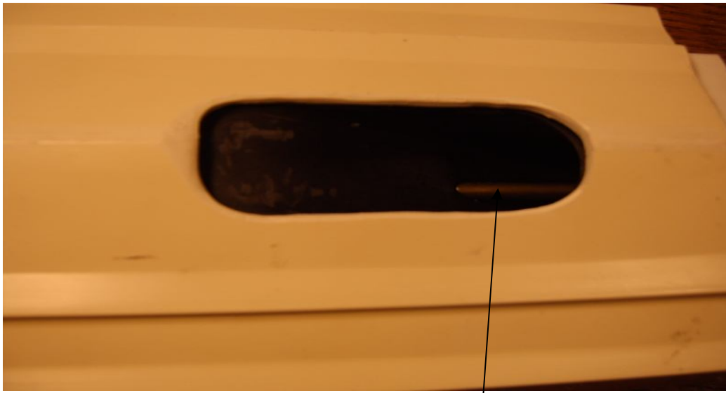
Die bearbeitete Einlassöffnung – man sieht auch die MS-Welle worauf der Impeller sitzt.
